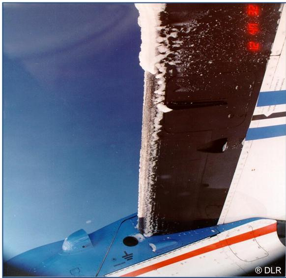
Abb. 1: DLR Dornier-228 Forschungsflugzeug nach dem Durchflug von Vereisungsbedingungen.
